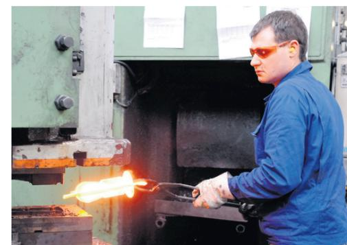
◆ **Abgraten:** Das überschüssige Material wird vom Schmiedestück mit einer Kraft von 160 Tonnen entfernt
